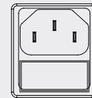
AC INPUT 100-240V - 50-60Hz - FUSE T1 AL 250V
