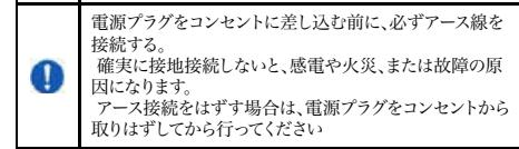
電源プラグをコンセントに差し込む前に、必ずアース線を接続する。
