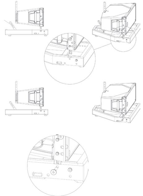
4) La parte frontale del diffusore inferiore in un array a stacking non deve essere necessariamente parallelo al palco o al telaio. Se necessario può essere inclinato verso l'alto o verso il basso. In questo modo gli array ad arco possono essere realizzati rapidamente da una posizione di fissaggio a terra.
