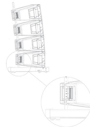
5) Il diffusore inferiore in un array a stacking può essere inclinato per poter scegliere l'area di copertura adeguata (da +7,5 a -7,5). Per il montaggio si posiziona la prima cassa sopra al ply bar e si collega adesso con lo stacking bar, scegliendo l'opportuno angolo di inclinazione. Il tutto viene infine bloccato usando i pin a corredo.
