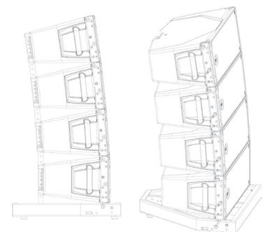
In seguito aggiungere i diffusori HDL uno a uno come indicato per le configurazioni sospese. Possono essere impilati e interconnessi fino a quattro diffusori HDL, utilizzando i componenti di fissaggio D-LINE standard e i subwoofer D-LINE come piano di appoggio.
