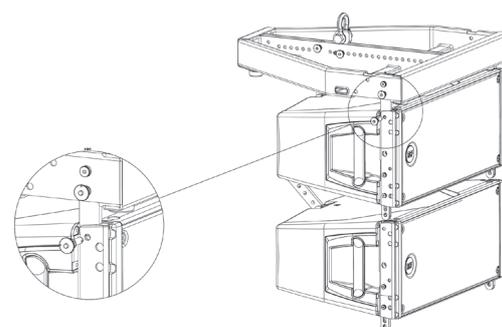
4) Invertire e collegare la staffa posteriore 1 alla barra di sospensione utilizzando 2 perni di bloccaggio rapido.
