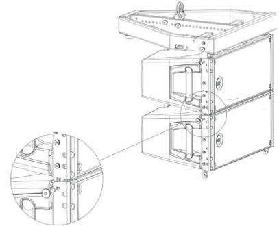
6) invertire e collegare la staffa posteriore del secondo diffusore utilizzando il foro per l'angolazione corretta.
