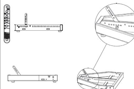
3) Collegare la staffa anteriore del primo diffusore HDL utilizzando 2 perni a bloccaggio rapido.
