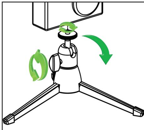
Equipment auf Stativ aufschrauben. Mit Hilfe der Rändelscheibe kann das aufgeschraubte Equipment gegebenenfalls arretiert werden.
