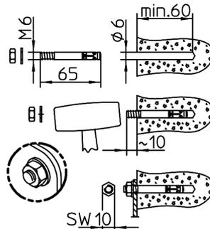
LOCHSTEINE: Rahmendübel  $\varnothing$  8 x 80 mm mit Holzschraube M6 x 85 mm; vorbohren  $\varnothing$  8 mm / 90 mm tief.
