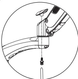
Führen Sie die Schraube durch die Bohrungen des Verlängerungsarme in Richtung der Abdeckkappen.
