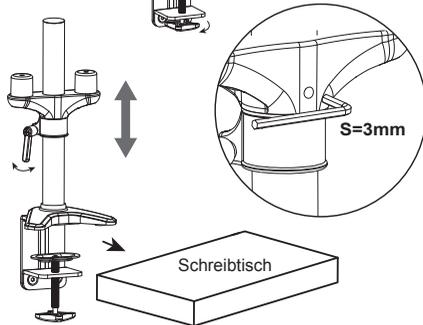
Bei einer Tischdicke von mehr als 60 mm (2,36") und höchstens 85 mm (3,35"), entfernen Sie die Klemmschraube von der unteren Aufnahme und bringen diese um 180° gedreht wieder an.
