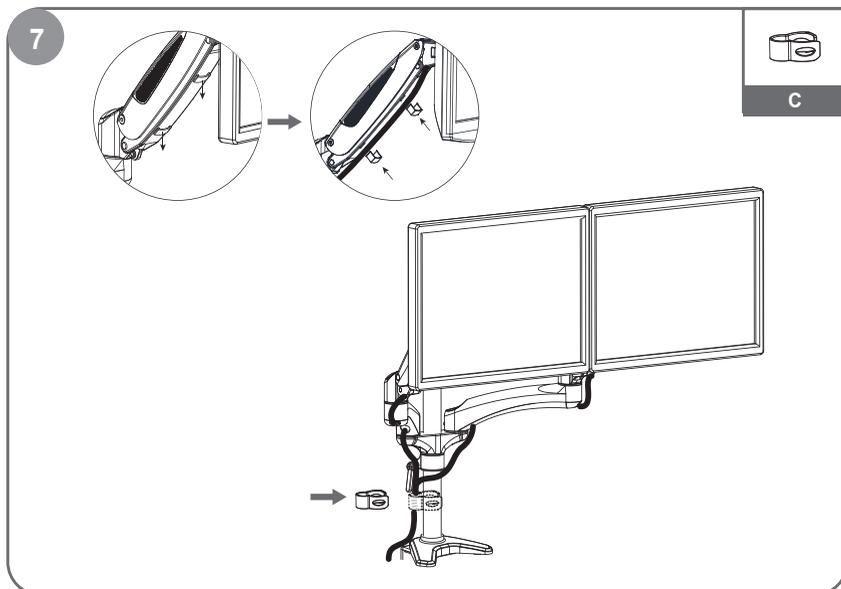
Führen Sie die Kabel in die Kabelabdeckungen ein. Verwenden Sie die Kabelklemme, um die Kabel am Grundrohr zu befestigen.
