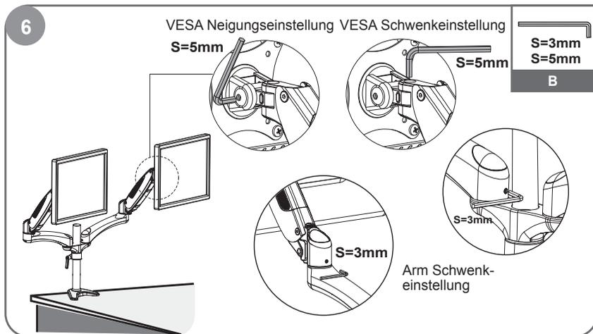
Verwenden Sie einen Innensechskantschlüssel, zur Einstellung der Beweglichkeit. Drehen Sie gegen den Uhrzeigersinn, um sie zu verringern und im Uhrzeigersinn, um sie zu erhöhen.
