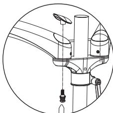
Führen Sie die Schraube durch die Bohrungen der Halterung in Richtung der Abdeckkappen.
