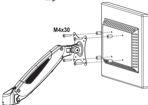
**Bündige Montage:** Montieren Sie die VESA-Halterung mit den der 4 Schrauben am Monitor.
