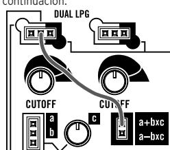
Gire el mando CUTOFF del LPG y el mando "c" de UTILITY para subirlos del todo, y ahora debería oír la señal de audio del transportador (carrier) de SOURCE. Ajuste los mandos MOD, RATIO y FOLD en diversos valores y escuche cómo cambia el timbre. A continuación, vamos a utilizar el módulo FUNCTIONS para modular el timbre de la señal del transportador (carrier) de SOURCE.
