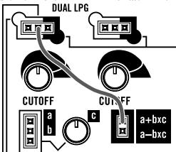
旋转调大 LPG 的 CUTOFF 旋钮和 UTILITY 的“c”旋钮，您应该能够听到 SOURCE 的载波音频信号。将 MOD、RATIO 和 FOLD 旋钮设定为不同的值，聆听音质如何变化。
