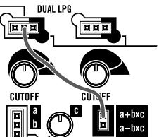
4. LPGのCUTOFFノブとUTILITYのcノブを時計回りに回すと、SOURCEのキャリア信号の音が聞こえます。SOURCEのMOD、RATIO、FOLDノブをさまざまな値にして、音色の変化を聞いてみましょう。
