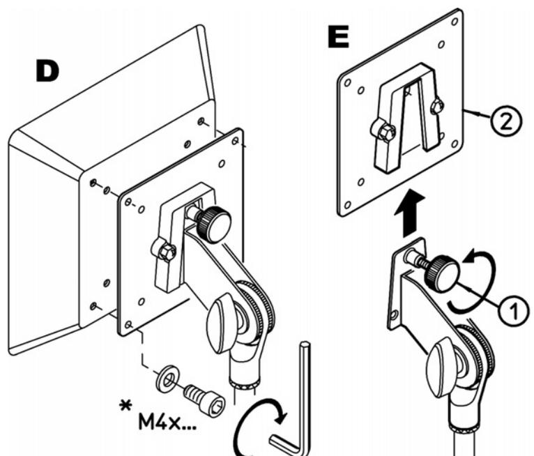
\* Die Befestigung erfolgt mittels vier Schrauben M4x... , welche jedoch nicht im Lieferumfang enthalten sind, da deren Länge von den Abmessungen des jeweiligen Bildschirms abhängen.
