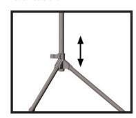
Schritt 7: Zur Einstellung der Höhe, Hebel an der Rohrkombination lösen und Auszugsrohre bis zur gewünschten Höhe herausziehen. Hebel dann wieder fest schließen.
