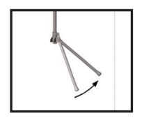
Schritt 6: Unteren Hebel oberhalb des Fußgelenks lösen und das Grundrohr bis zum Anschlag herausziehen. Hebel wieder feststellen.
