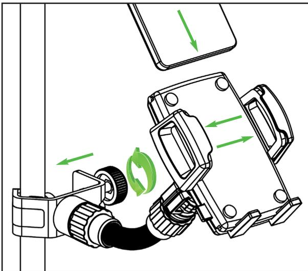
Klemmprisma an Stativrohr anlegen und die Klemmschraube an der gewünschten Position festziehen.
