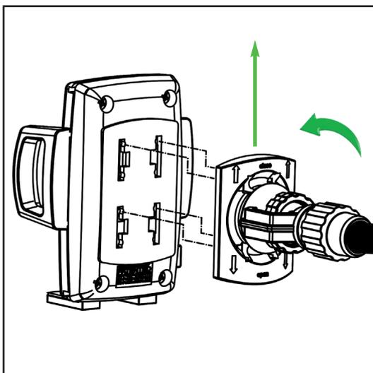
Die vier Haken der Rastplatte in den Smartphone-Halter stecken und die Rastplatte in Pfeilrichtung CLOSE schieben. Der Smartphone-Halter rastet hörbar auf der Rastplatte ein. Bei Bedarf kann der Smartphone-Halter um 180° gedreht montiert werden. Dies kann nötig sein, wenn Bedienelemente am Smartphone vom Halter verdeckt werden. Die Auflagebügel müssen in diesem Fall in die gegenüberliegende Nut montiert werden.
